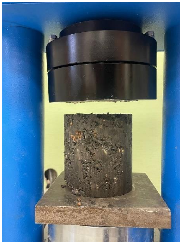
Рисунок 2.7 – Вид образца при испытаниях на сжатие
