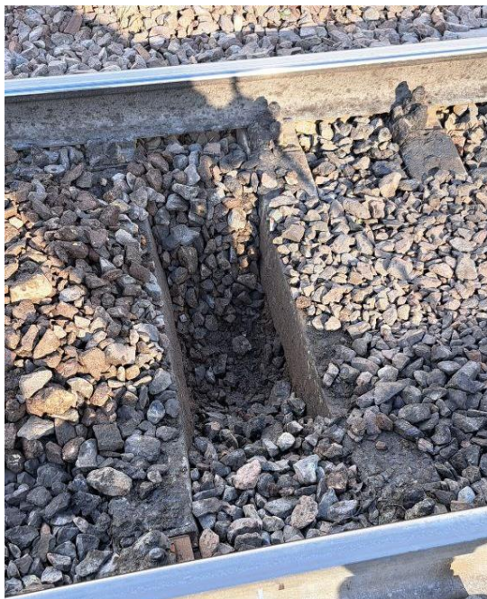
Рисунок 4.1 – Отбор образца старогодного балластного материала
