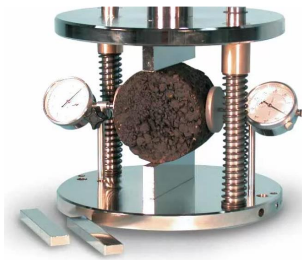
Рисунок 1.4 – Схема испытаний на растяжение при расколе
