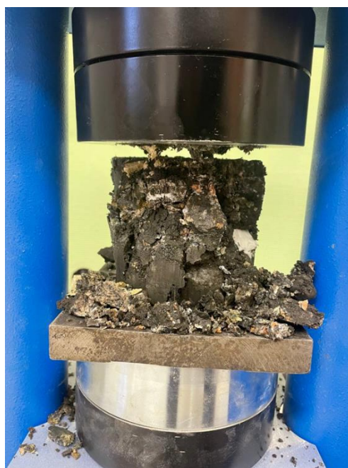
Рисунок 2.8 – Вид образца после испытаний
