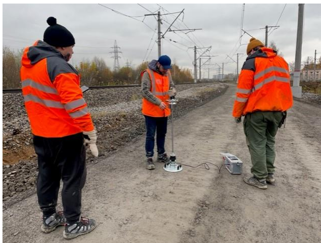
Рисунок 3.11 – Определение динамического модуля деформации
